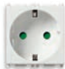
14208.AB Presa SICURY 2P+T 16 A 250 V~, standard tedesco - 2 moduli. Prof.tà: 28,4 mm
