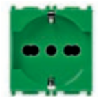
14210.AB.V Presa SICURY 2P+T 16 A 250 V~ universale, verde - 2 moduli. Prof.tà: 25 mm
